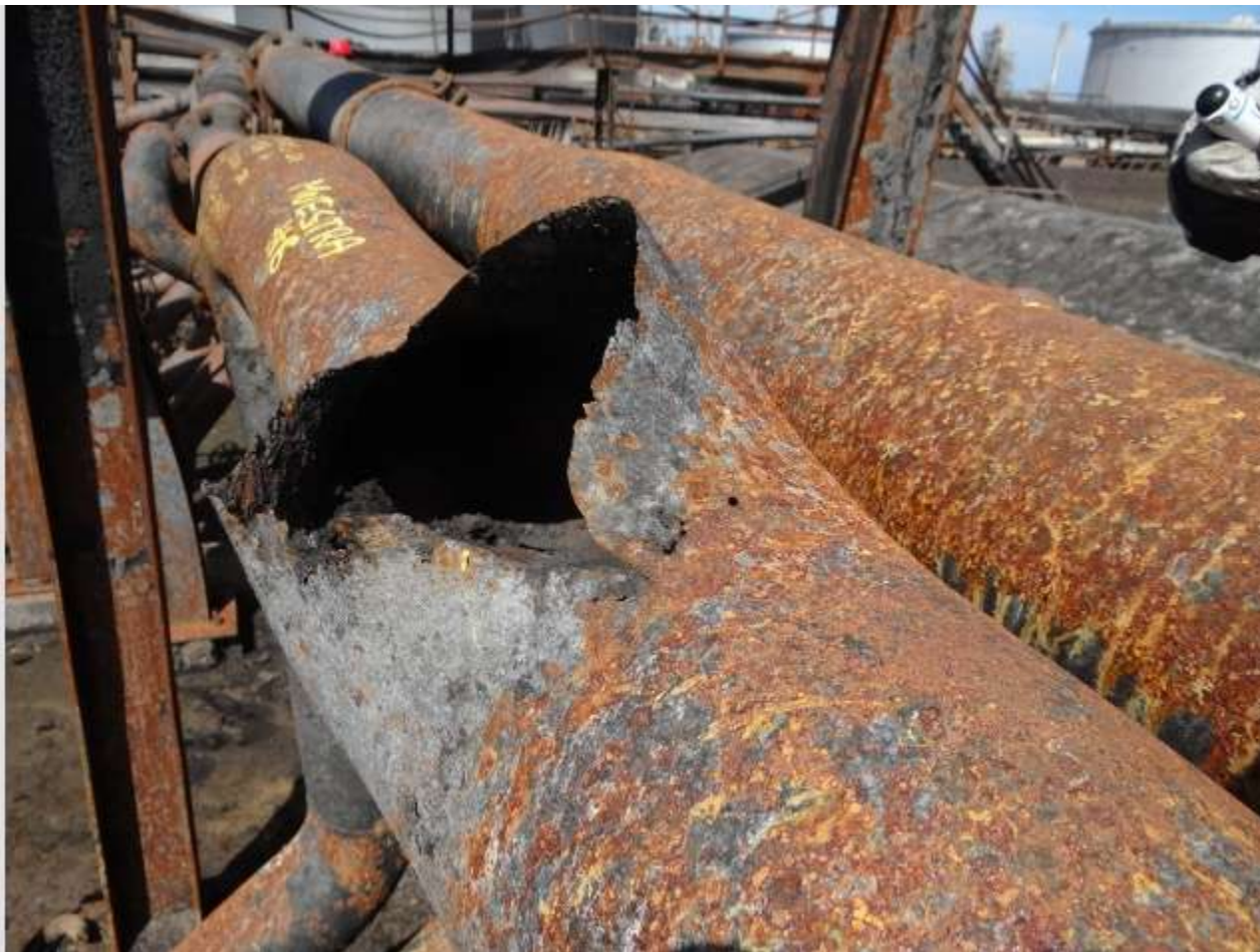
Muestra N°6. Línea de Olefinas del TK-208 a la Succión de las P-1601/P-2601 / P-200 A-B-C
