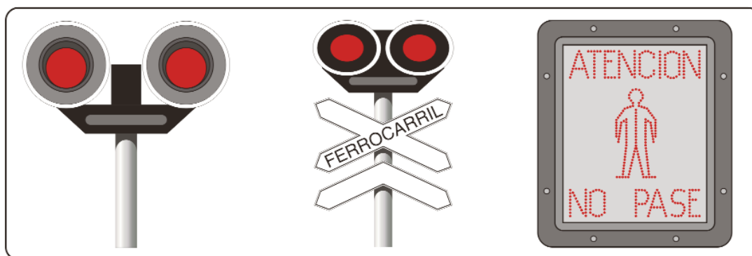
Figura 9.6. Ejemplo de semáforos utilizados en pasos a nivel
