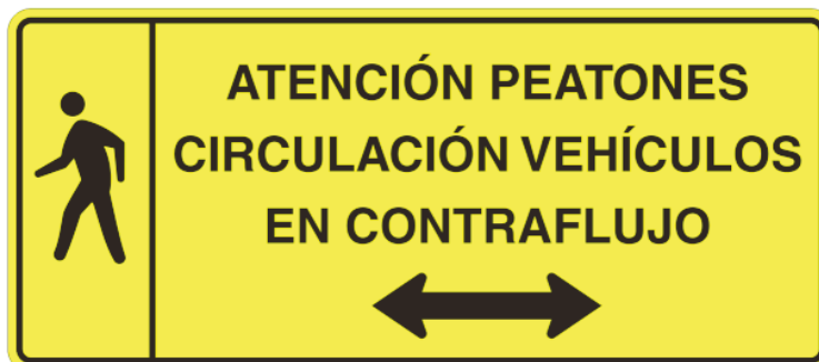
Figura 8.12. Señales de prevención que indique al peatón la circulación de vehículos en contraflujo de un canal (P6-7)
