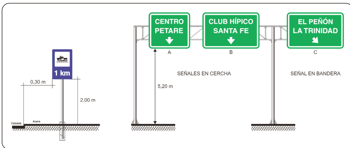
Figura 2.37. Altura y espacio lateral libre de señales de información en zona urbana
