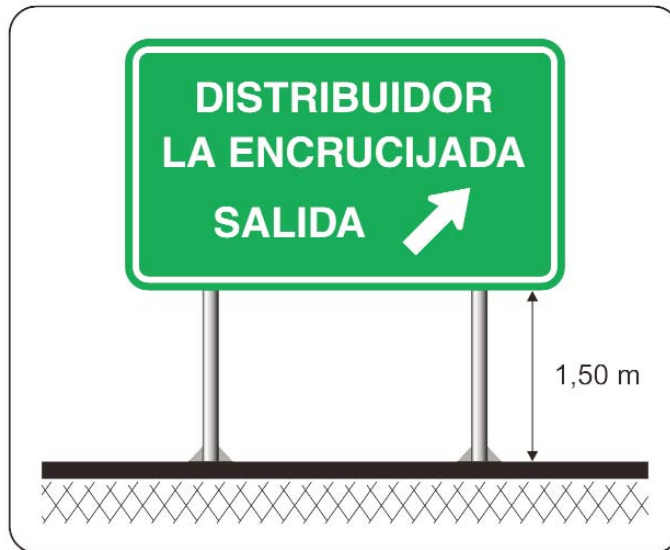
Figura 2.53. Señal informativa de confirmación en dos postes
