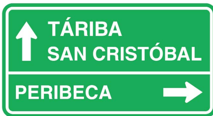
Figura 2.56. Señal de información para indicar dos destinos en una misma dirección
