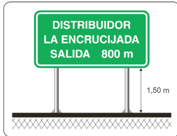
Figura 2.51. Señal de preseñalización en dos postes
