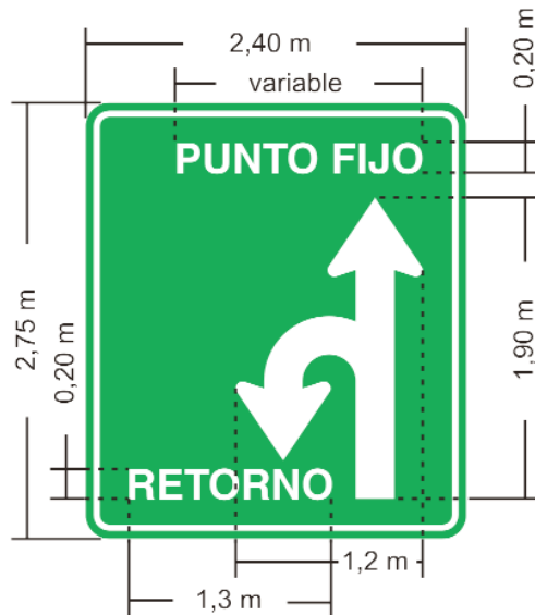
Figura 2.45. Diseño de flechas que indican retorno y movimiento pronunciado
