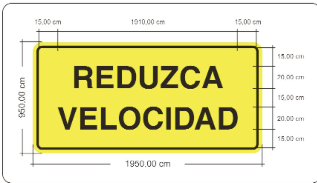
**Figura B18. Dimensiones de la señal Reduzca Velocidad**
