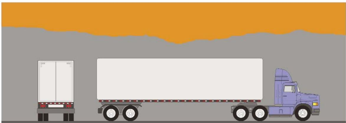
Figura C1. Ubicación de bandas retrorreflectivas en vehículos de carga
