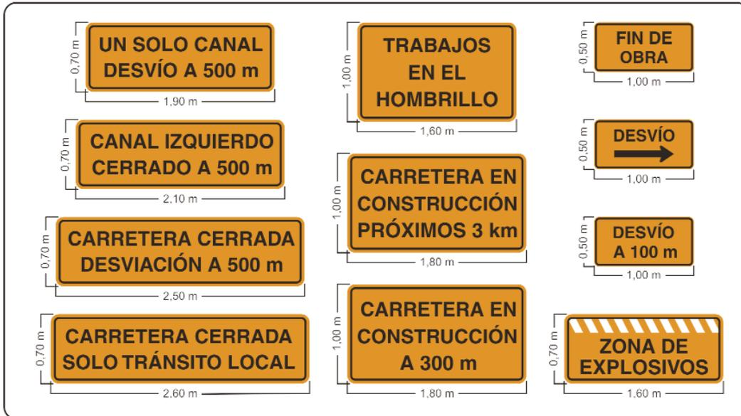
Figura B21. Dimensiones de diferentes señales temporales (rectangular)
