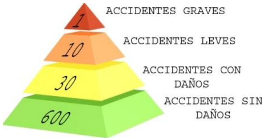
Figura Nro. 4. Modelo de Causalidad de Frank E. Bird (1969) Basado en Insurance Company of North America (ICNA)
